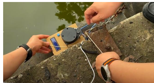
Hình 5. Lắp đặt thiết bị cảm biến trên bờ cập tàu tại Hồ An toàn
