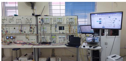
Hình 6. Phần cứng mô phỏng lưới điện
