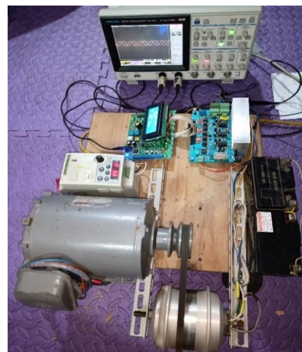
Hình 10. Hệ thống thực nghiệm hãm tái sinh
