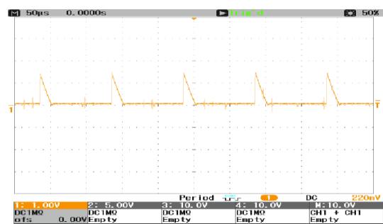
Hình 15. Dòng nạp ắc quy, thang đo 3A/div, 1µs/div
