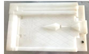
Hình 2. Khuôn dập ngói bằng vật liệu UHMWPE OK 2000 sau khi phay CNC
