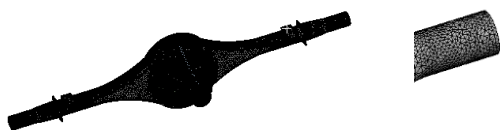
Hình 2. Mô hình chia lưới vỏ cầu trong Ansys với phần tử tiêu chuẩn có kích thước là 5mm
