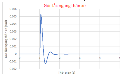
Hình 10. Góc lắc ngang thân xe \theta_{sx} khi V=60\text{km/h}
