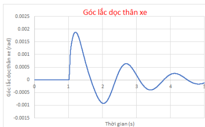
Hình 9. Góc lắc dọc thân xe \theta_{sy} khi V=60\text{km/h}
