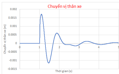
Hình 7. Chuyển vị thân xe Z_s khi V=60\text{km/h}
