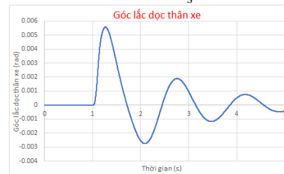
Hình 13. Góc lắc dọc thân xe \theta_{sy} khi V=80\text{km/h}
