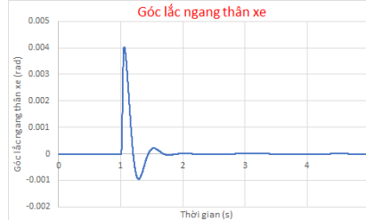
Hình 6. Góc lắc ngang thân xe \theta_{sx} khi V=40km/h
