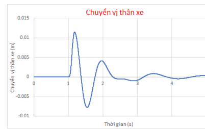
Hình 11. Chuyển vị thân xe Z_s khi V=80\text{km/h}
