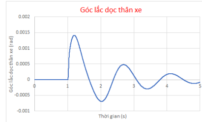
Hình 5. Góc lắc dọc thân xe \theta_{sy} khi V=40km/h
