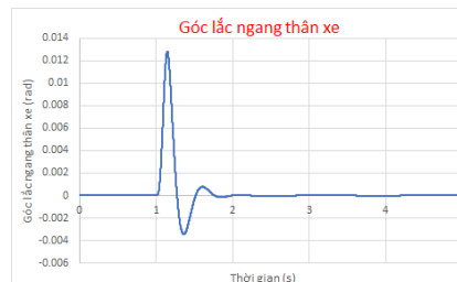
Hình 14. Góc lắc ngang thân xe \theta_{sx} khi V=80\text{km/h}
