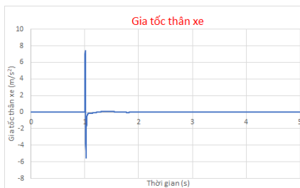
Hình 8. Gia tốc thân xe \ddot{z}_s khi V=60\text{km/h}
