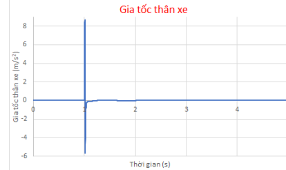
Hình 12. Gia tốc thân xe \ddot{z}_s khi V=80\text{km/h}
