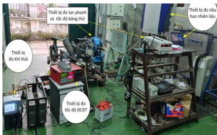
Hình 11. Mô hình lắp hoàn thiện cùng các thiết bị đo
