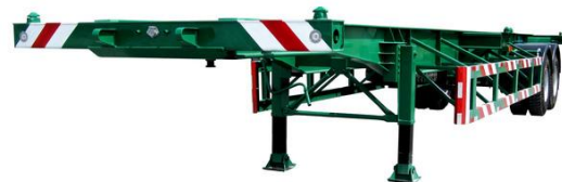
Hình 2. Xe bán moóc chở container 40 feet, 2 trục Bảng 2. Các thông số cơ bản khung SMRM 40 feet, 2 trục
