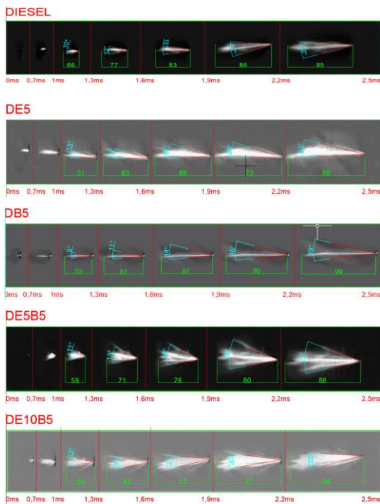
Hình 3. Cấu trúc tia phun nhiên liệu diesel, DE5, DB5, DE5B5 và DE10B5
