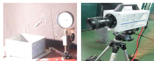
Hình 1. Thiết bị kiểm tra tia phun nhiên liệu a) Thiết bị cân chỉnh vòi phun b) Máy quay Photron Fastcam SA3
