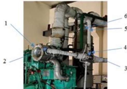
Hình 2. Hệ thống hoàn lưu khí thải trên động cơ 6LU32
