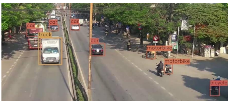
Hình 5. Hình ảnh kết quả phát hiện phương tiện giao thông từ đường Nguyễn Bình Khiêm
