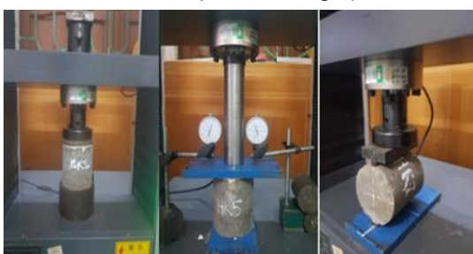
Hình 5. Thí nghiệm mẫu khoan HK1 đến HK9
