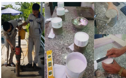
Hình 4. Công tác khoan lấy mẫu ngoài hiện trường và chuẩn bị mẫu để thí nghiệm
